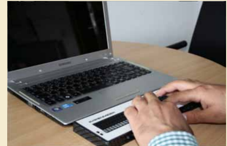
Abb. 2: Mobiler Blindenarbeitsplatz (mit 40er Braillezeile und Notebook)
